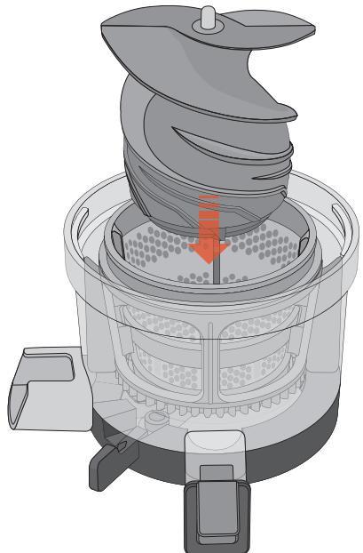
**4** ドラムキャップをドラムに組み立て、時計回りに止まるまで回します。
