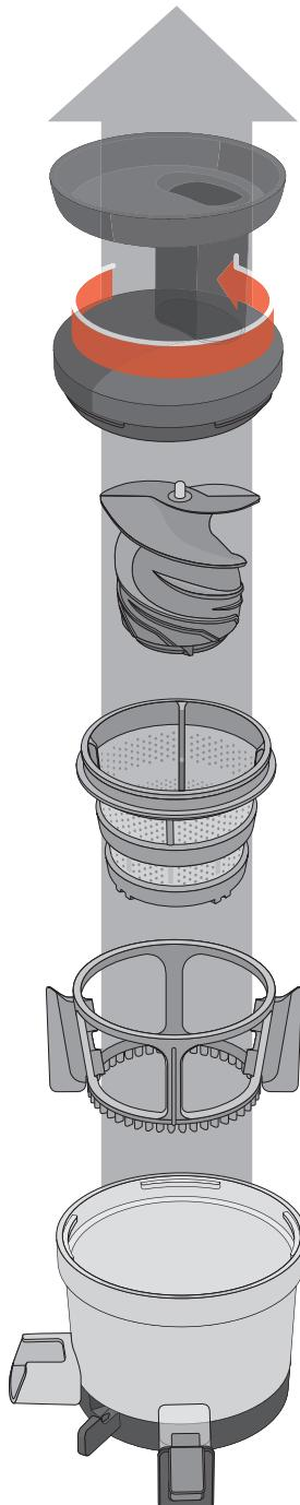
1 ドラムキャップを反時計回りに回して外します。
