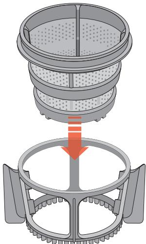
2 [1]で組み立てた部品を図のようにドラムに取り付けます。取り付けた後、右に回すと力チップはまり固定されます。ドラムの溝とストレーナーの突起を合わせると、固定されます。
