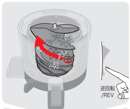
1 作動スイッチの[逆回転/REV]ボタンを3~5秒間押して手を離す操作を2、3回繰り返してください。
