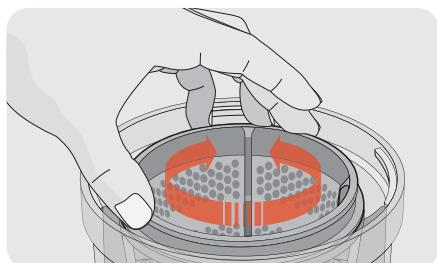
**3** ストレーナーの中にスクリューを図のように組み立てます。
