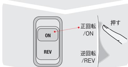
2 作動スイッチの[正回転/ON]を押します。
