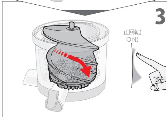
逆回転動作が完全に停止した後、[正回転(ON)]ボタンを押して稼働させます。
