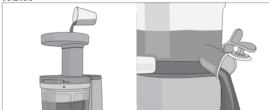
**1** ジュースキャップを閉じた後、水を入れて作動させます。
