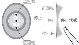
搾汁が終了したら、作動スイッチの[逆回転/REV]を押して停止させます。
