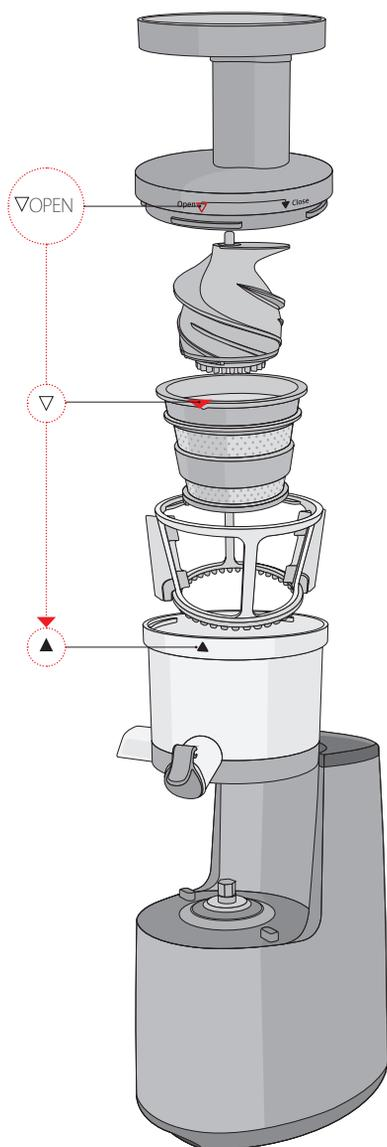
**STEP 4** ドラムの[▲]点とドラムキャップの[▽OPEN]が直線上に位置するようにしてドラムキャップを閉じた後、時計方向に回します。ドラムの[▲]点とキャップの[CLOSE ▼]が合うまで回してください。
