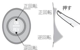
作動スイッチの[正回転/ON]を押します。
