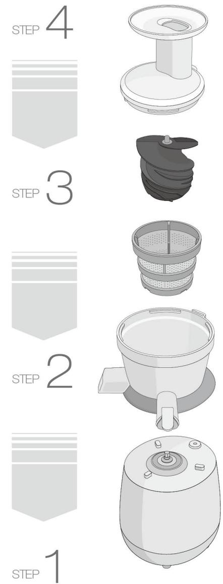
本体>ドラム>ストレーナー>スクリュー>ドラムキャップの順に組立てた後、ドラムキャップを時計回りに回して閉めてください。
