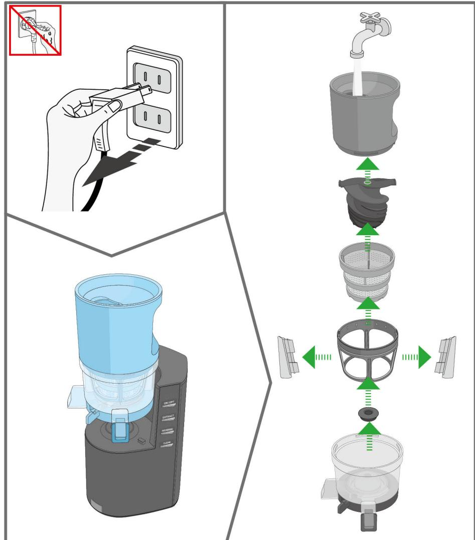
ドラムセットを本体から外します。ドラムセットは組み立て時と逆の順番で分解します。ドラムセットは掃除ブラシを使用し水を流しながら洗浄してください。本体はしっかりと絞ったタオルや柔らかい布で拭いてください。パッキン類は定期的に取り外して洗浄してください。
